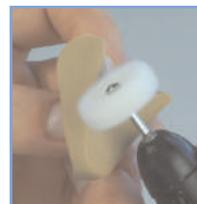
**14.** Glätten der Oberfläche erfolgt mit den Lisko-Polierscheiben fein, weiß. Die Orthese aus Erkoton ist nun fertig und kann direkt am Fuß getragen werden.
